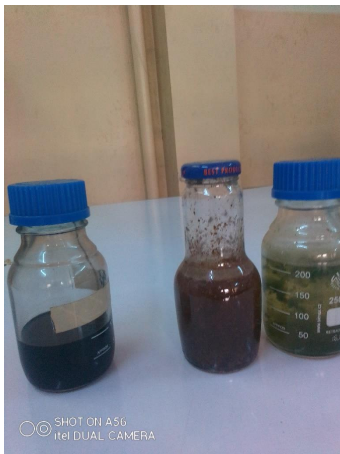
Figure 3 : à gauche (huile non traitée) au milieu (traitement mi-chemin) et à droite (traitement final)
