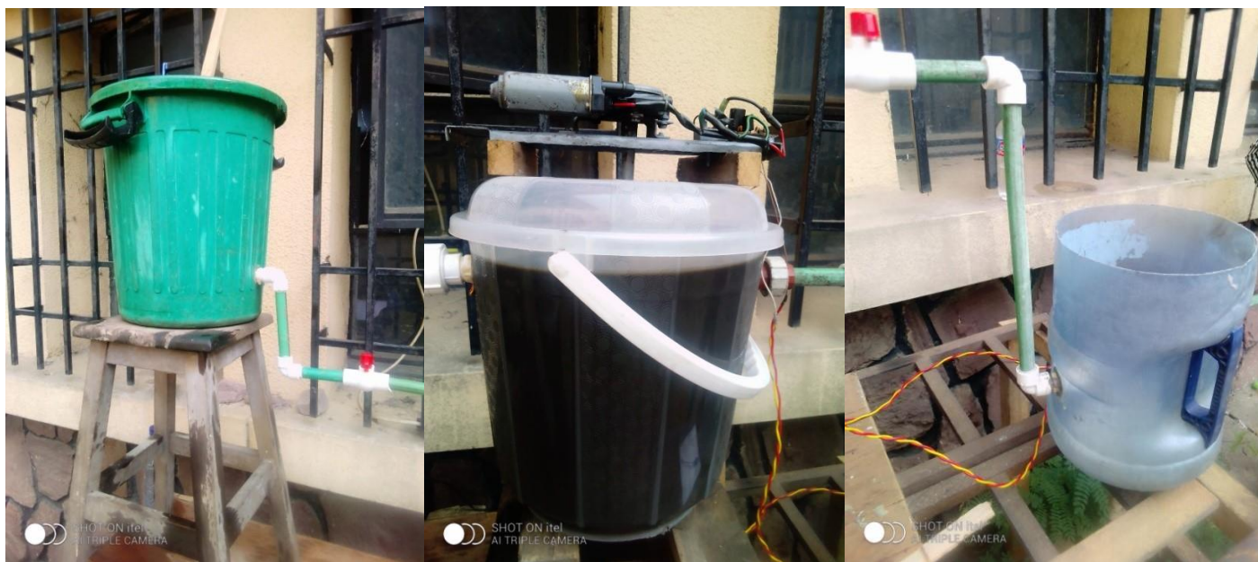
Figure 2 (b) : (a) bassin de relevage, (b) bassin d'aération et (c) bassin de decantation
