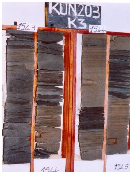
Fig. 7. Un aperçu des carottes de K2, on remarque un faciès microconglomératique, avec une légère imprégnation d'huiles, [15]
