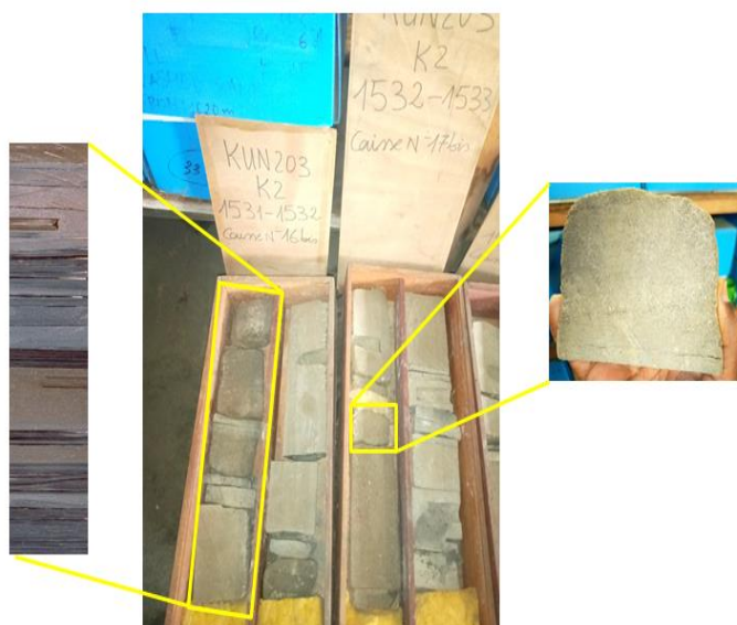
Fig. 6. Vue d'ensemble des carottes de K3, le faciès est gris à brun-verdâtre, microconglomératique et imprégné d'huiles [16]
